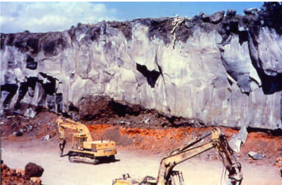
Fig.1 – Fronte di cava in cui è visibile la sezione della colata. Si può notare la successione dei vari strati con caratteristiche diverse: lo strato superiore (grigio scuro) è costituito da scorie, lo strato intermedio, di spessore più consistente (grigio chiaro), è la roccia basaltica (“*affilato*”), da cui si ricavano i conci lavici; in basso si intravede la “*rifusa*”, di spessore variabile e, ancora più giù, la cosiddetta “*agghiara*” di colore rosso. (Foto E. Lo Giudice).
